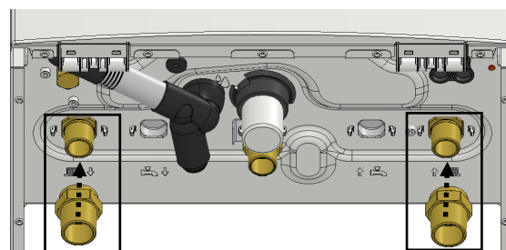
Conexiones de suministro y retorno
